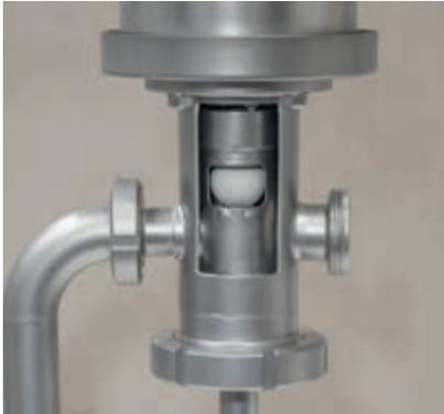
Die integrierten Düsen sorgen für eine effektive Innenreinigung sowie für die Reinigung des Vakuums- und Sicherheitsventils.
