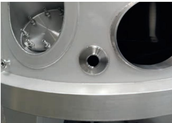
Tankeinschweißflansche werden in die Behälterwandung oder den Behälterboden eingeschweißt.
